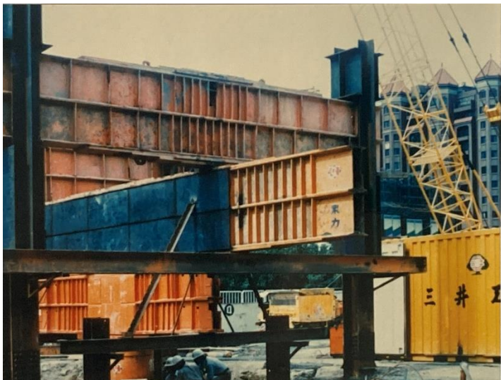
基樁試樁 反作用力之假設構台 < 採最高標準形式
