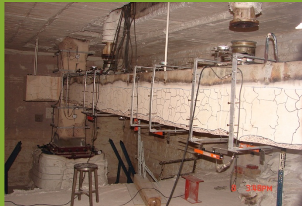
RC樑柱接頭耐火試驗
