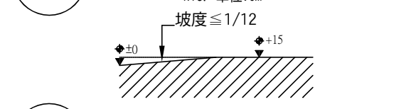
C'型路緣斜坡剖面圖(二)
