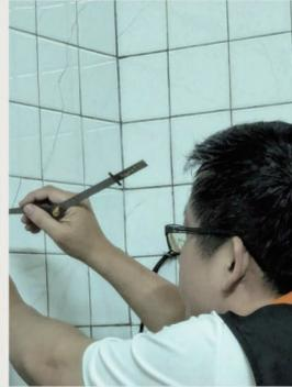
磁磚裂縫塞尺檢測
