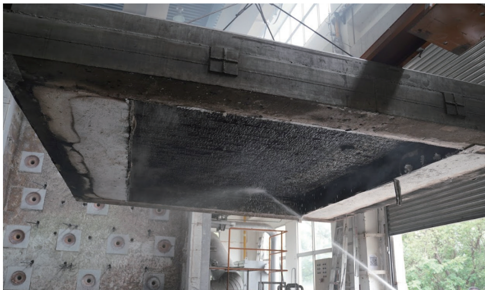
CLT 樓板 1 小時防火實驗。
