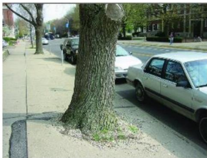
圖 2-24 根系發育需要寬廣的地下空間，但樹穴過小使根系生長受到限制。(ISA 提供)
