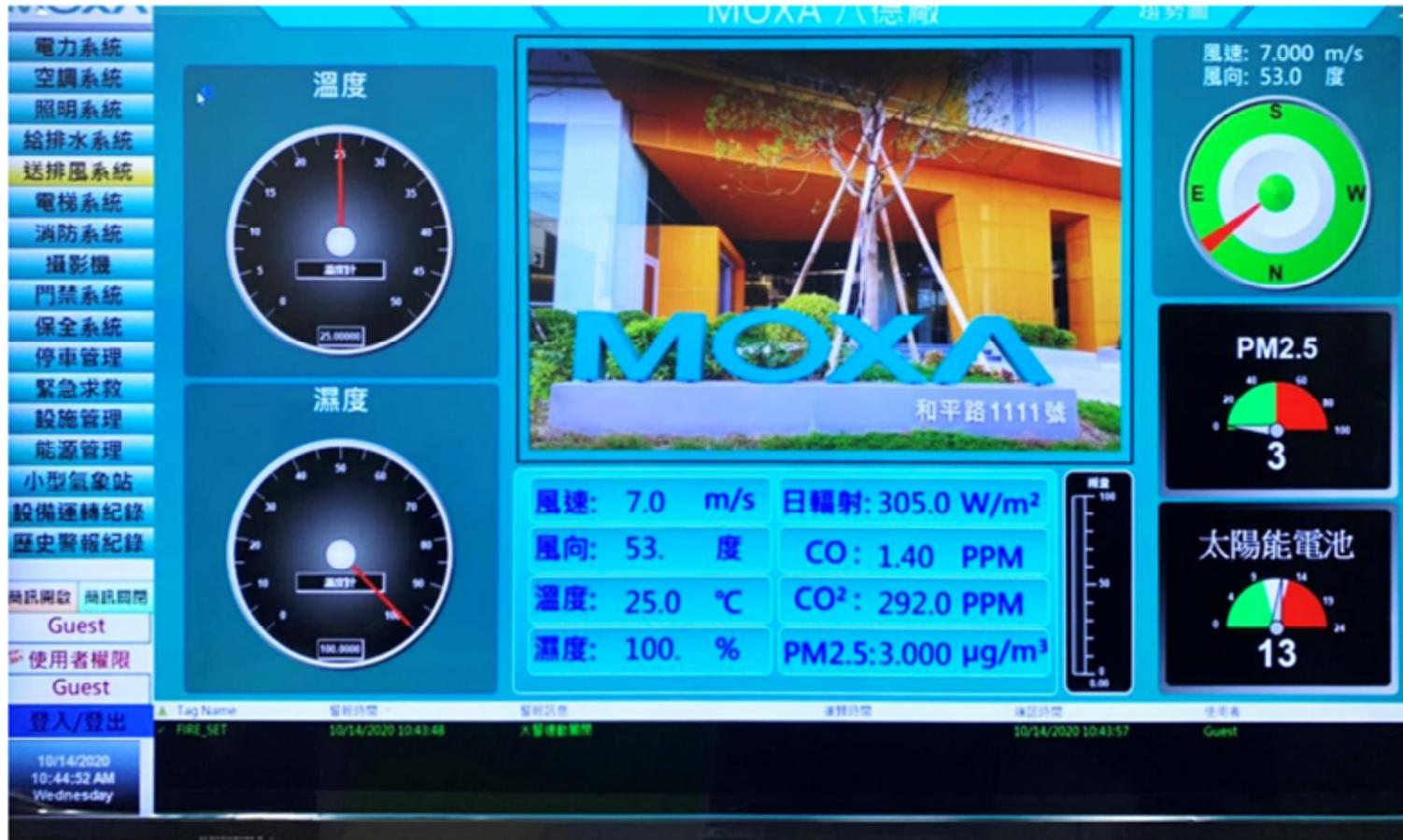
中央監控系統具備**Web化操作環境**，整合電力、空調、照明、衛生給排水、送排風、電梯、消防系統，具備設備使用狀態與故障監視及事件發生之處置歷史功能，具圖資視覺化操控、遠端緊急通報
