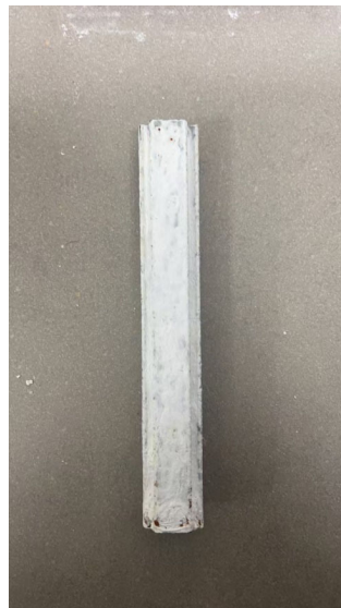
TECE龍骨在鹽霧測試 240小時下的狀態
