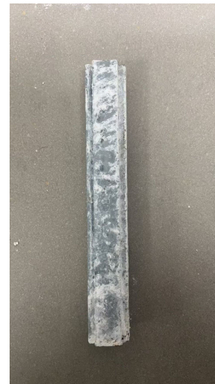
TECE龍骨在鹽霧測試 100小時下的狀態
