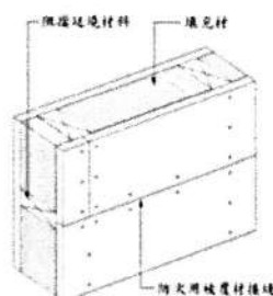
圖9.3-6 防火被覆用板材接縫部分與阻擋延燒材料示意圖範例（二）
