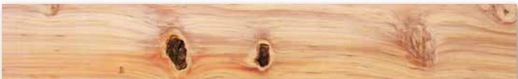
CNS 14630 「針葉樹結構用製材」甲種 II 類結構用製材之 2 等材外觀
