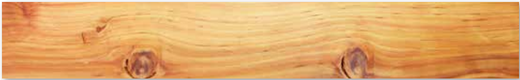
CNS 14630 「針葉樹結構用製材」甲種 II 類結構用製材之 3 等材外觀
