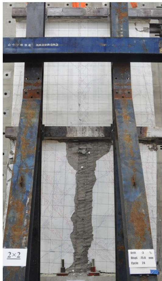
圖 4.22 2x2 試體不同層間位移角試體破壞情況(續)
