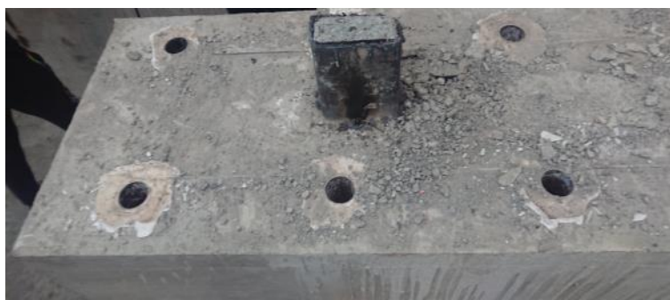
圖 4.24 2×2 試體鋼管內混凝土填充狀況
