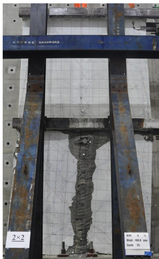
圖 4.22 2×2 試體不同層間位移角試體破壞情況(續)
