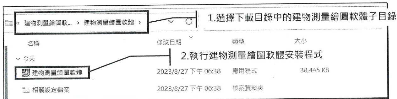
圖 25 安裝建物測量繪圖軟體 1
