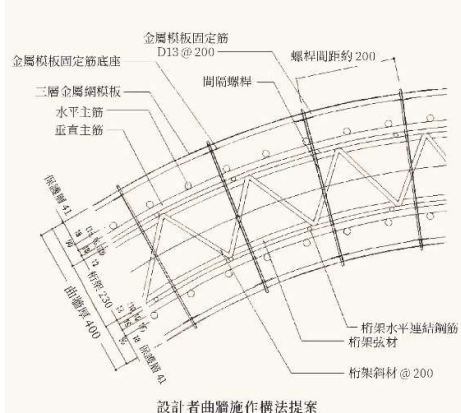
桁架鋼筋及主筋曲牆單元工廠組裝
