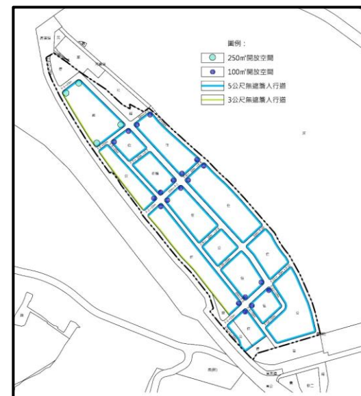
附圖 2 退縮建築及開放空間規定示意圖
