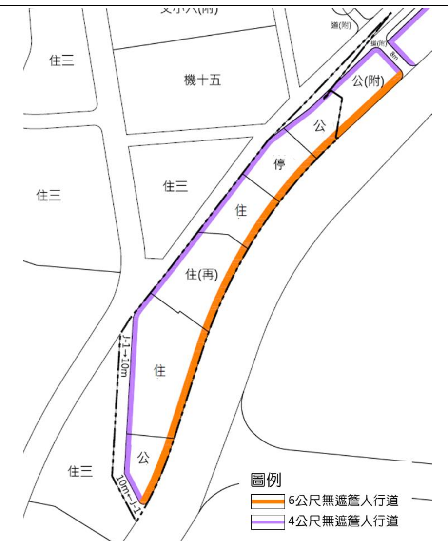
附圖 2 退縮建築規定示意圖
