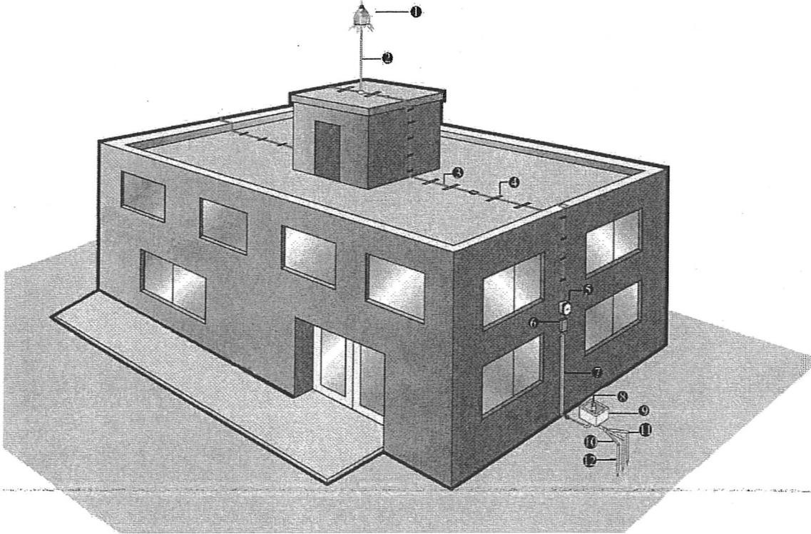
①提早閃流放射式避雷針②安裝支撐杆③引下線銅帶/線④引下線固定夾子⑤雷擊計數器⑥測試夾⑦保護套⑧接地夾⑨接地觀測井⑩接地銅線 ⑪接地棒與銅線的固定夾 ⑫接地棒
